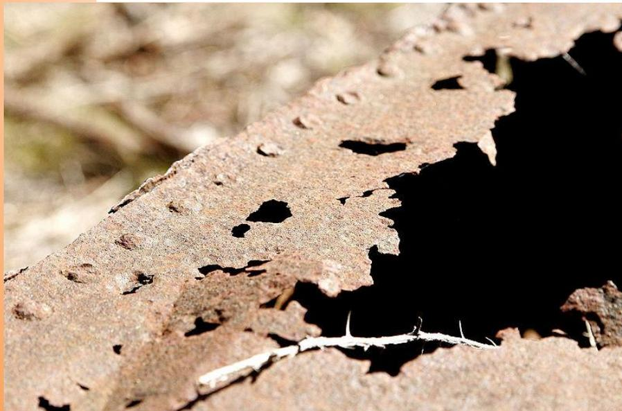
Una mancha de óxido se comporta como cátodo frente al hierro no oxidado, formando una pila o par bimetalico que **acelera** el fenómeno natural de corrosión.
