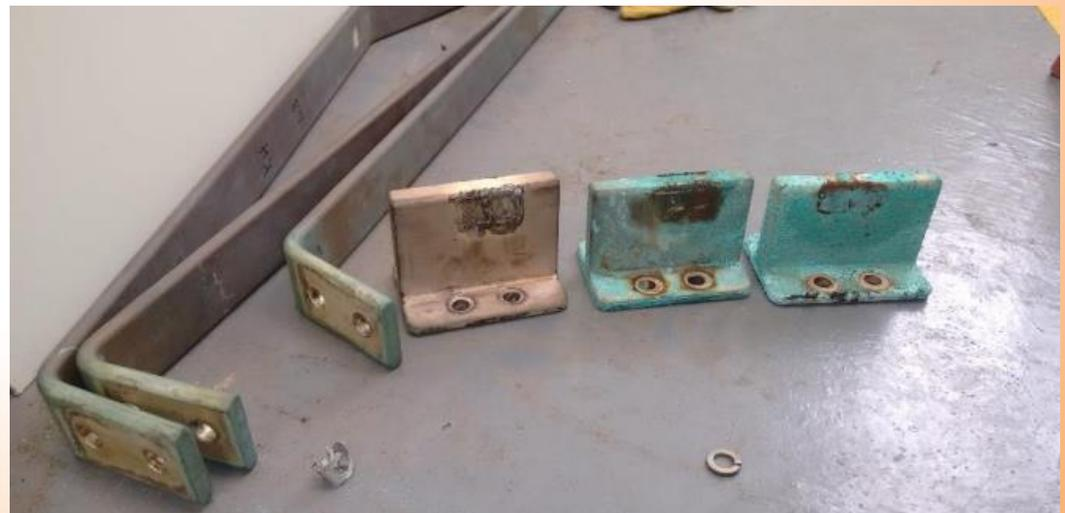
Corrosión excesiva en contactos de una celda de 13,8 kV
