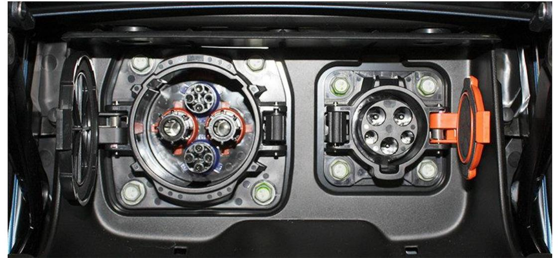
Toma de corriente del Nissan Leaf, compatible con CHAdeMO (rápida, CC) y SAE J1772 (convencional, CA).
